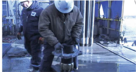
(d) Make the core bit ready
