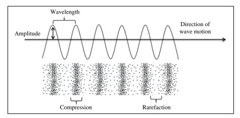
FIGURE 7.3 Longitudinal P-wave.
