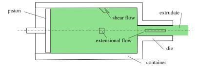
Fig. 4.21 Extrusion
